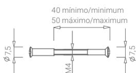
**Parafuso com fêmea fixação** Screw with female fixation
