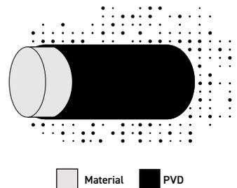
PVD (Physical Vapor Deposition) trata-se de um revestimento cerâmico fino de elevada aderência, realizado num processo de deposição por plasma altamente ionizado numa câmara de vácuo. Elevada resistência à oxidação, resistência ao desgaste e aos raios UV.
