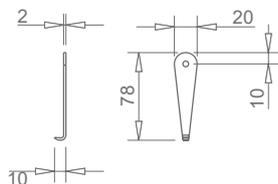
**Chave de desmontagem** Assembly key
