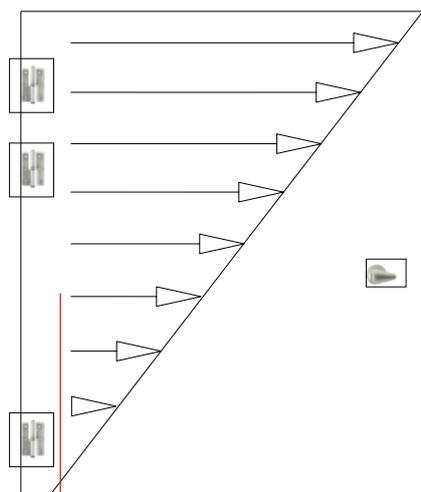
Esforço radial sobre o fiel da dobradiça de fixação da porta.
